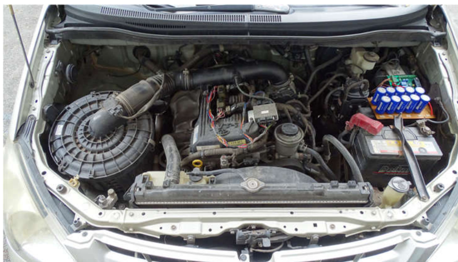
Hình 4.11: Các bộ phận của hệ thống thu hồi, tích lũy năng lượng điện cảm được lắp trên ô tô thử nghiệm
