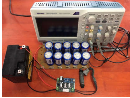
Hình 4.6: Thực nghiệm khả năng đáp ứng của kim phun
