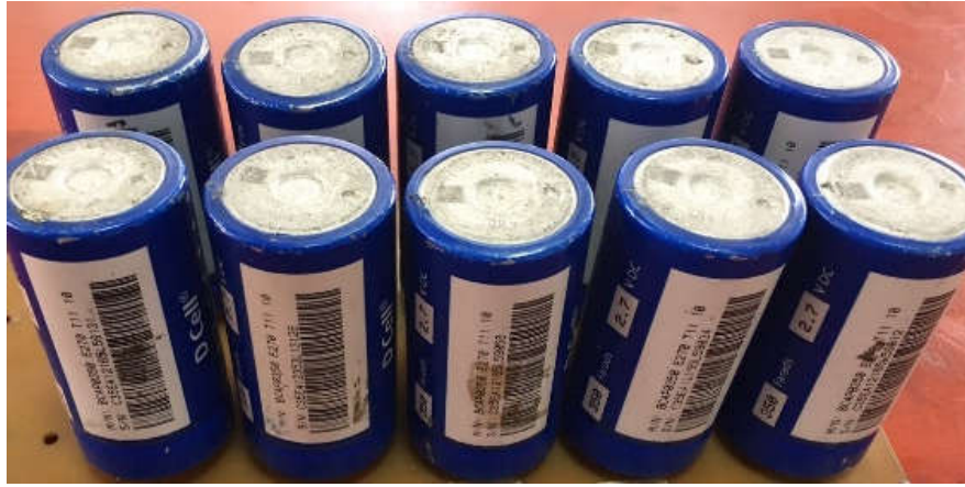
Hình 3.18. Khối 10 siêu tụ Maxwell BCAP0350 mắc nối tiếp
