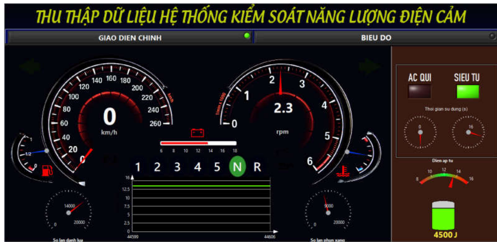
Hình 3.16. Giao diện thu thập dữ liệu và kiểm soát năng lượng điện cảm
